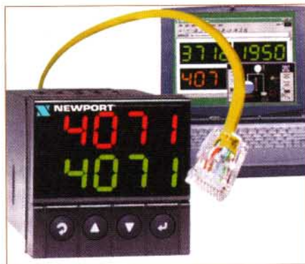
▲ La petite prise RJ45 est tout un symbole : les indicateurs de tableau se connectent désormais sur Ethernet et accèdent à Internet.
